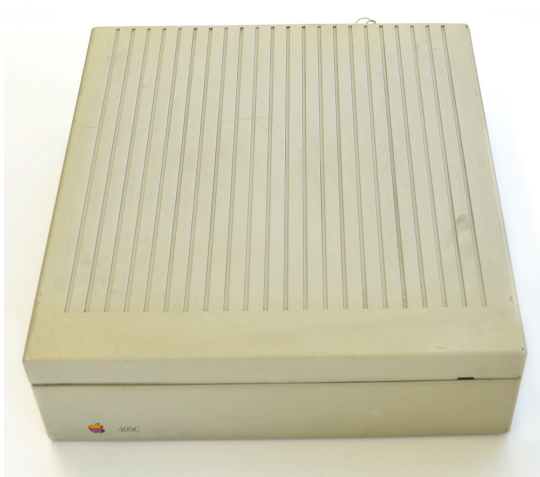
Figura 2. Disco rígido não amovível de 40 MB da Apple. Houve vários destes discos na Faculdade acoplados a Macintosh Plus na década de 1990. Caixa de plástico rígido com as dimensões de 27x24x8 cm.
