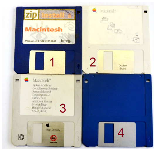
Figura 5. As populares disquetes do Séc. XX eram discos flexíveis de 9 cm em estojos de plástico rígido. As da figura tinham a capacidade de 720 KB (1 e 2) ou de 1440 KB (3 e 4). Estas últimas apresentam um orifício no canto superior esquerdo: de origem (3) ou feito com uma broca ou com o furador de um canivete suíço (4). Esta operação fazia com que uma disquete originalmente de 720 KB passasse a ter a capacidade de 1440 KB.
