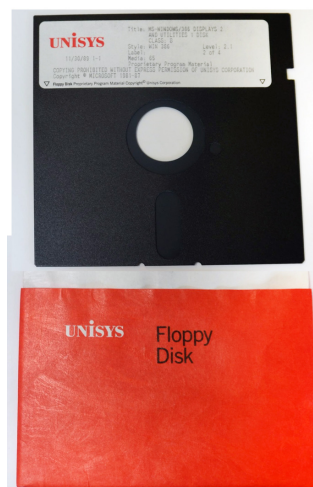
Figura 1. Disco flexível de 13 cm de diâmetro com invólucro protetor de cartolina e bolsa de arquivo, com 720 KB de capacidade. Usavam-se em PCs tipo IBM.
