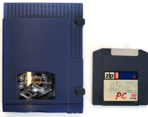
Figura 4. Figura 4. Disco flexível amovível Zip de 100 MB com 9 cm de diâmetro em estojo de plástico rígido. Havia destes discos disponíveis tanto para PCs tipo IBM como para Macintosh. Leitor também de plástico rígido e de dimensões relativamente pequenas.
