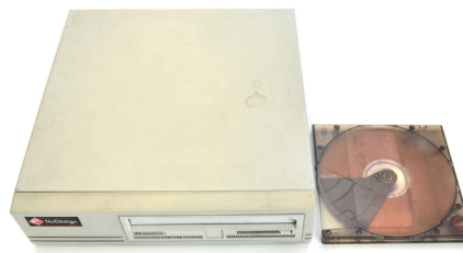
Figura 3. Disco rígido amovível Nu Design com cerca de 13 cm de diâmetro. Embora estes discos tivessem a vantagem de serem amovíveis, tinham no entanto apenas 44 MB de capacidade e um leitor bastante volumoso. Talvez se trate do único exemplar deste género e marca que funcionou na Faculdade. O leitor está numa caixa metálica, com as dimensões de 27x24x6 cm.
