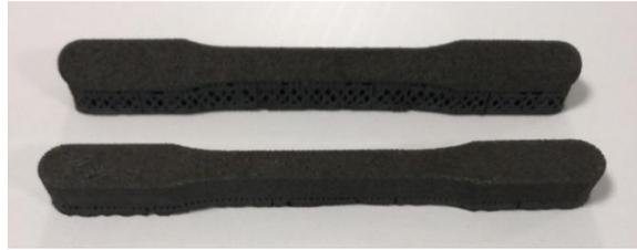
Figura 31 - Dois provetes sujeitos ao tratamento de solubilização; um a 45° e outro a 0°; a) antes do tratamento; b) após o tratamento
