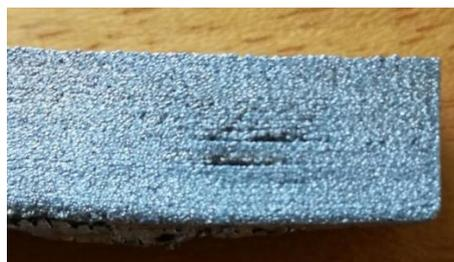
Figura 33 - Imagem de um dos provetes *Charpy* produzidos no *build job* 6, onde é possível observar fissuras
