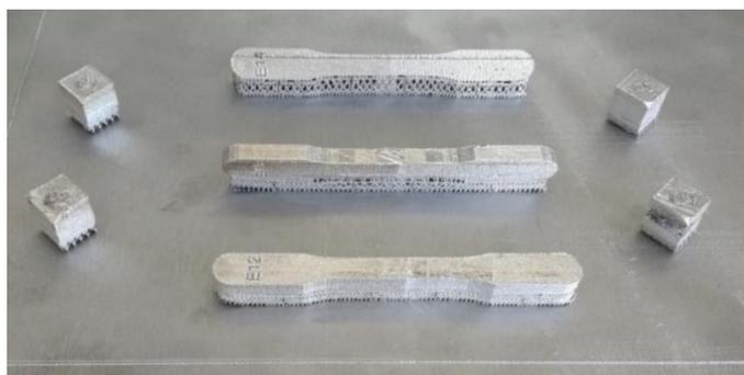
Figura 29 - Imagem das partes produzidas no substrato metálico do *build job* 5
