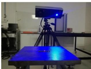
Figura 20 - Equipamento de engenharia inversa e respetivo provete digitalizado
