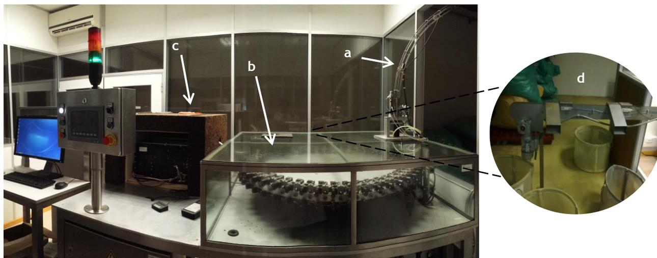
Figura 1 - Máquina de deteção individual de TCA. Constituída por: a) alimentação; b) incubação; c) análise cromatográfica e d) segregação.
