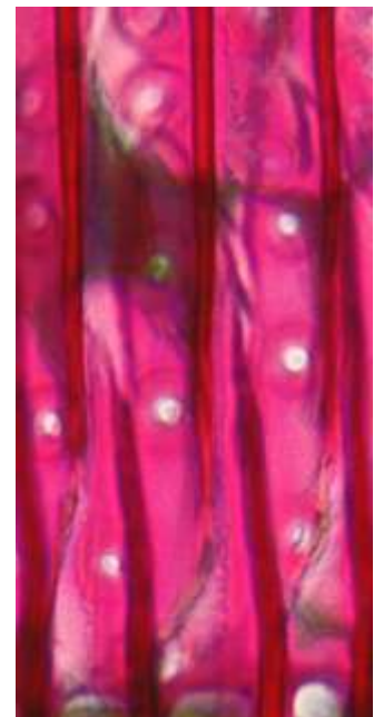
Figura 3. tracóides de Pinus com pontuações areoladas. É possível observar as extremidades em bisel
