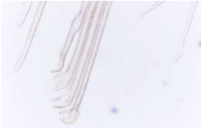
Figura 7. Fibro-tracóides, obtidos por maceração de madeira de Tsuga sp.
