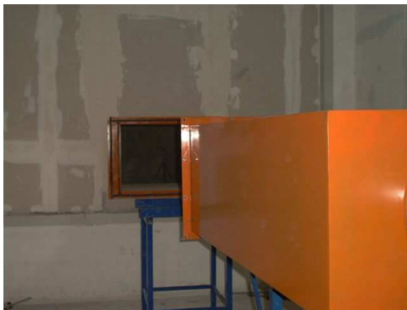
Ensaio de atenuadores sonoros nas câmaras
