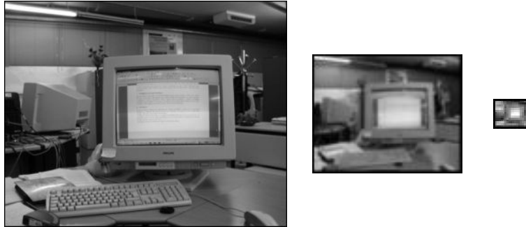
Fig. 13 - Exemplo de construção de uma estrutura piramidal com 3 níveis, a partir da imagem original (à esquerda).
