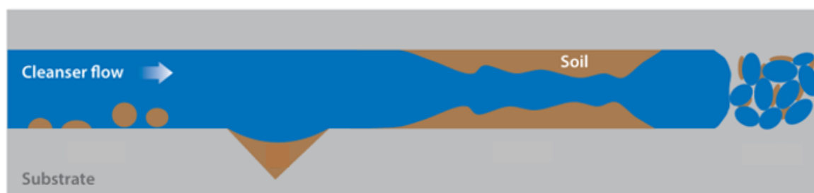
Figura 9: Exemplo esquemático de um sistema de limpeza composto por três fases: fluido de limpeza, resíduos de sujidade e o substrato sólido, extraído de [14].
