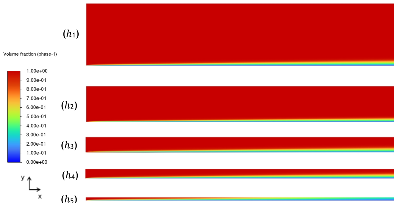
Figura 19: Contorno da fração mássica de desgordurante alcalino e tensioativo para as alturas ( h ) estudadas.
