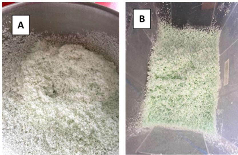
FIGURA 37 - A) – TAMPO TRITURADO; (B) – ESPUMAS TRITURADAS
