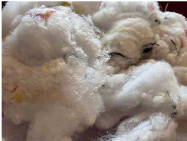
FIGURA 29 - PROCESSADO QUE RESULTA DA TRITURAÇÃO COM ALGODÃO
