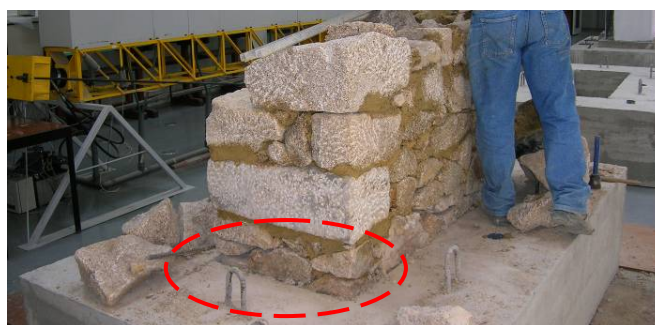
Figura 7: Zona onde foi posicionado o LVDT 17.
