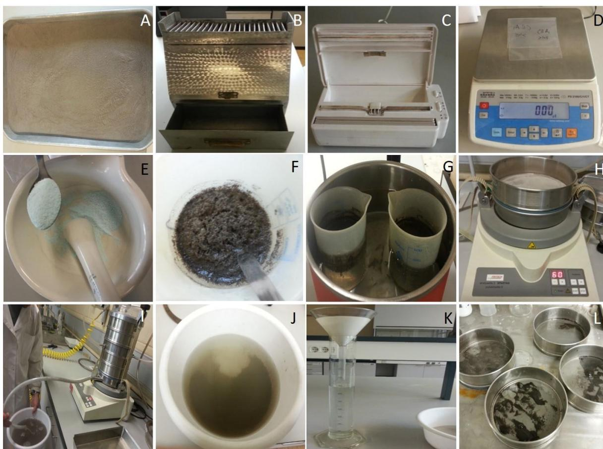
Figura 5 Métodos e equipamentos utilizados na metodologia – parte 1: A) CV do ciclone tal qual recebidas; B) Quarteador de ferro bi compartimentados; C) Dispositivo de selagem das amostras; D) Balança; E) Pastilha de Calgon triturada; F) Exemplo da aplicação de ultrassons; H) Base do separador granulométrico; I) Exemplo do ensaio de peneiração mecânica húmida; J) Bacia de recuperação de finos após repouso; K) Exemplo do processo de filtragem; L) Peneiros antes da recolha da amostra.
