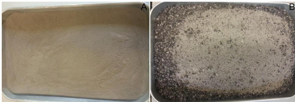
Figura 3 - CV resultantes da combustão de pó de cortiça: A) Cinzas do ciclone; B) Cinzas do recuperador.
