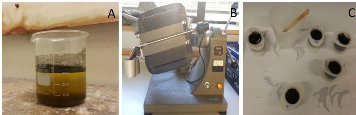
Figura 9 - Métodos e equipamentos utilizados na metodologia - parte 3: A) Tratamento com HCl; B) Dispositivo utilizado no ensaio Frantz; C) Exemplo do processo utilizado nos blocos polidos.
