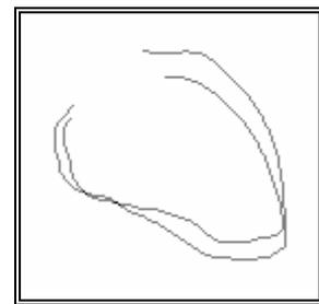
Figura 125 - Contornos 1 e 2 com os pixels ligados por segmentos de recta.
