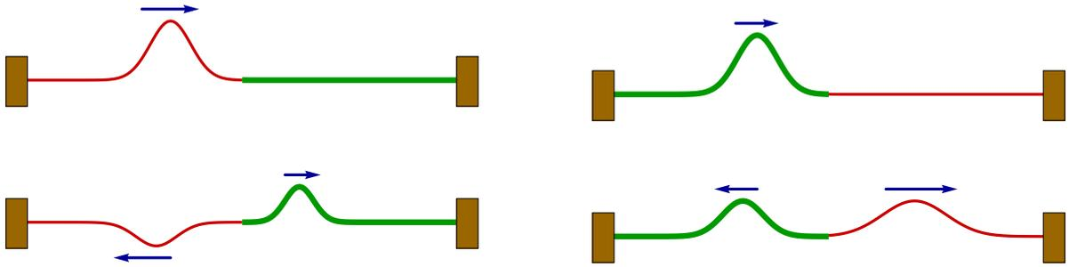
Figura 5: Onda a passar de uma corda com massa linear menor para outra com massa linear maior (esquerda), e de uma corda mais densa para outra menos densa (direita).
