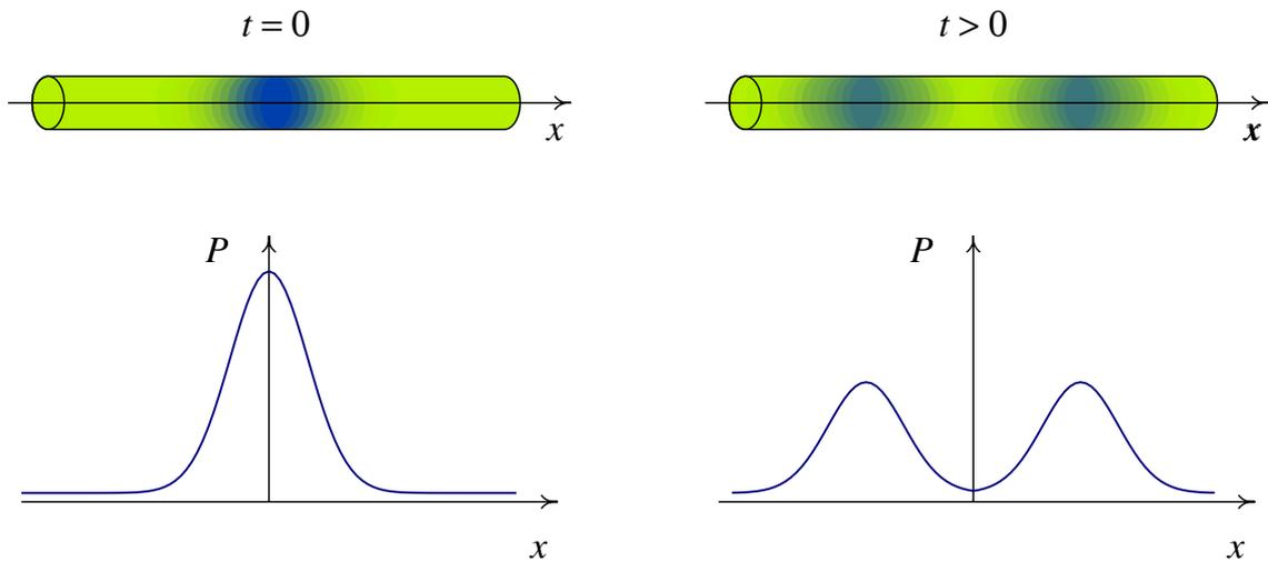
Figura 2: Onda de pressão numa coluna de gás.
