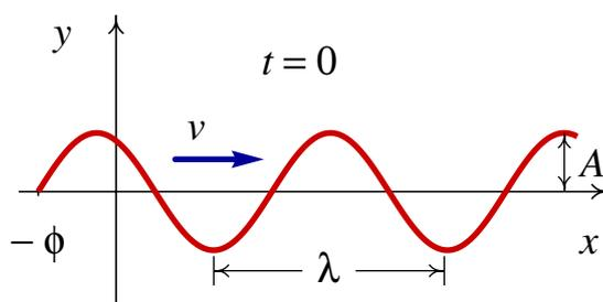
Figura 3: Onda harmónica.
