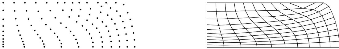
Figura 5.13: Geometrias correspondentes a uma redução em altura igual a 50% obtidas respectivamente pelo método EFG e pelo MEF, em que se considerou  $m_f = 1,0$ .
