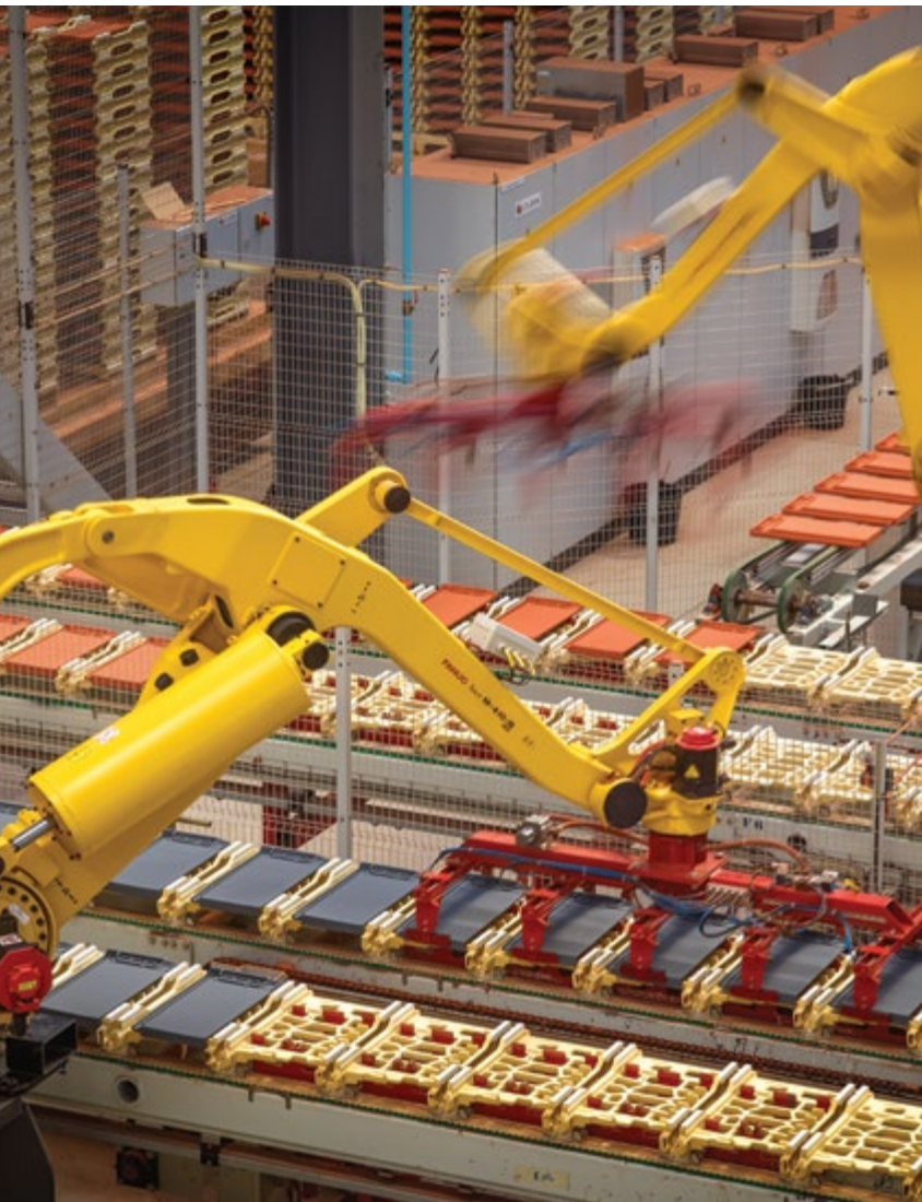
Linha de produção robotizada para o fabrco de telhas. Cortesia CS-Telhas / Robotized production line of roof tiles. Courtesy of CS-Telhas
