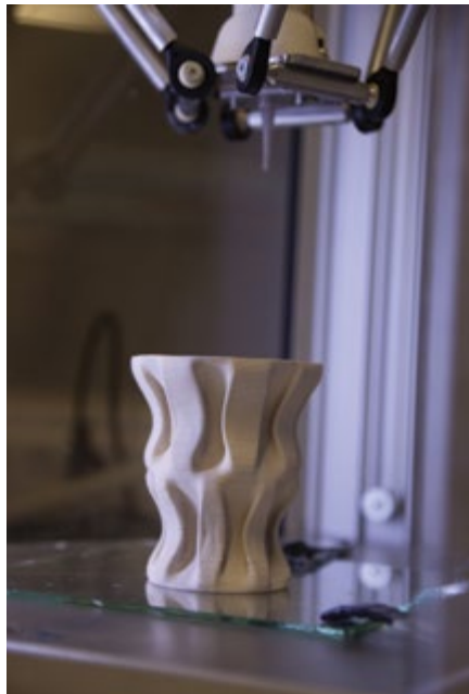
Impressão 3D de peças cerâmicas para desenvolvimento de produto novos em termos de design. Foto: CPV / 3D printing of ceramic parts for the desing and development of a new product. Photo credits: CPV
