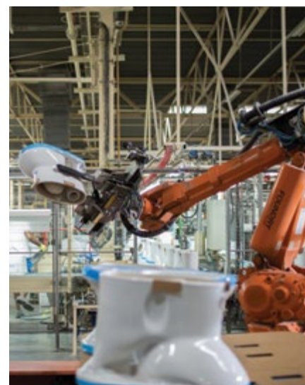
Braço Robótico utilizado na fabricação de peças cerâmicas. Cortesia Roca / Robotic arm used in the manufacturing of ceramic parts. Courtesy of Roca
