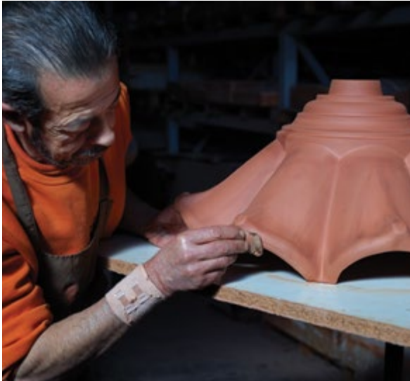
Execução manual de peças excecionais. Cortesia CS-Telhas/ Manual execution of extraordinary pieces. Courtesy of CS-Telhas
