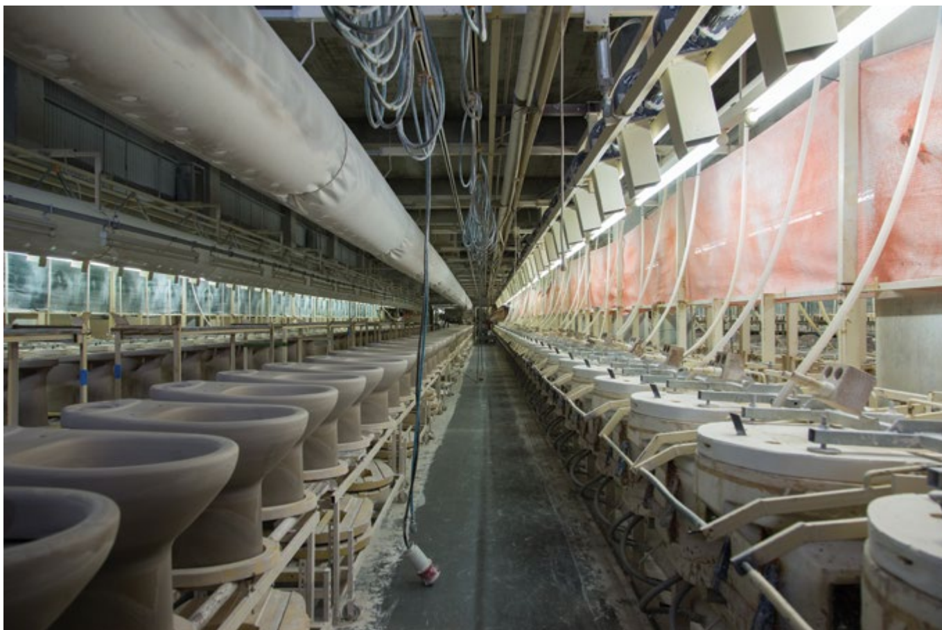
Linha de produção de loiça sanitária. Cortesia Roca/ Sanitary ware production line. Courtesy of Roca
