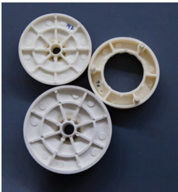
Desenvolvimento, no CTCV, de cerâmica técnica de alta precisão e elevada resistência ao desgaste obtida por injeção de pós cerâmicos. Fotos: CPV / Development of high precision ceramics with high abrasion-resistant grade, by injecting of clay fillers . Photo credits CPV
