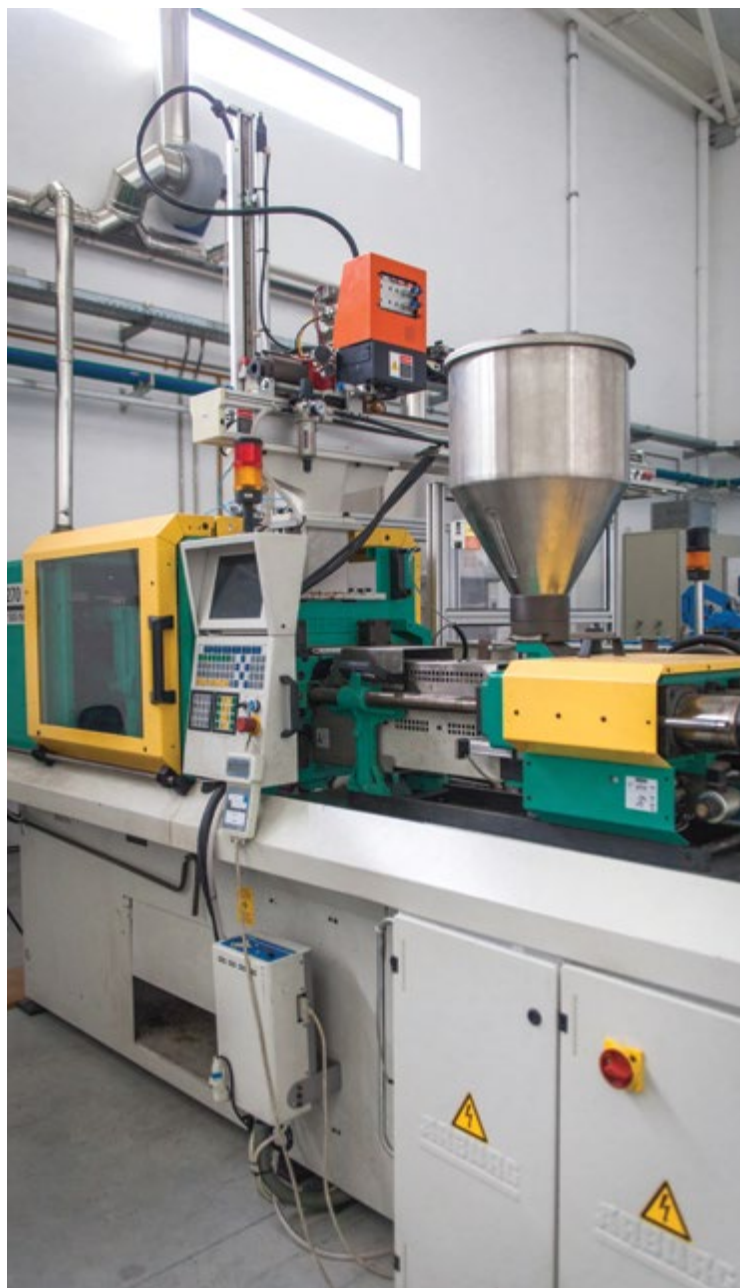
Desenvolvimento, no CTCV, de cerâmica técnica de alta precisão e elevada resistência ao desgaste obtida por injeção de pós cerâmicos. Fotos: CPV / Development of high precision ceramics with high abrasion-resistant grade, by injecting of clay fillers . Photo credits CPV
