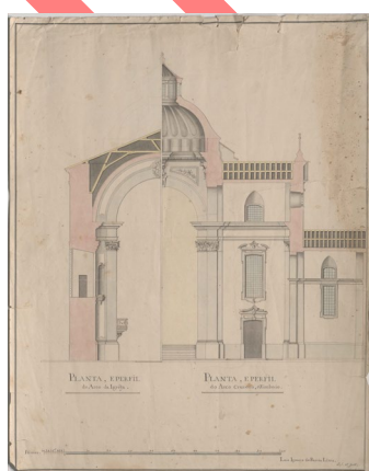
Figure 2: Transversal Section through the nave and transept by Luís Inácio Barros Lima. Arquivo da Irmandade de São Torcato.
