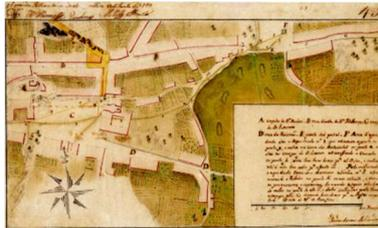
Figura 25 – “Planta da zona entre a Capela de Santo André e a Rua do Senhor do Bonfim, mostrando a arca de água junto à Ponte das Patas, o traçado do aqueduto que dá parte para a cerca do Convento de Santo António, Campo de São Lázaro e fonte, e o novo traçado proposto, por Teodoro de Sousa Maldonado”, 1795.
