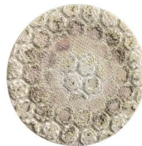
Figura 4.5 - Aspeto do disco da amostra RF_AL_RS1 no 3º ciclo do ensaio.
