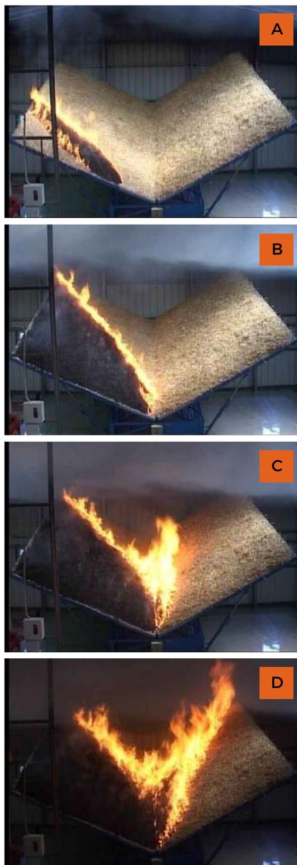
Figura B34 | Imagens de ensaios laboratoriais que permitem intuir o comportamento que o fogo terá tomado quando atravessou a linha de água no desfiladeiro: A) 0m30s; B) 2m45s; C) 3m02s; D) 3m11s.
