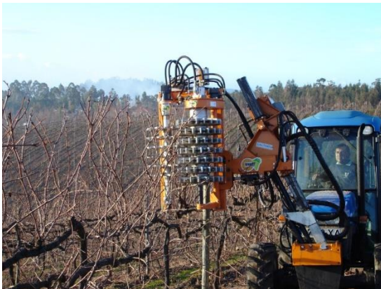
Figura 5.1 – Pré-poda mecânica e Desponta mecânica
