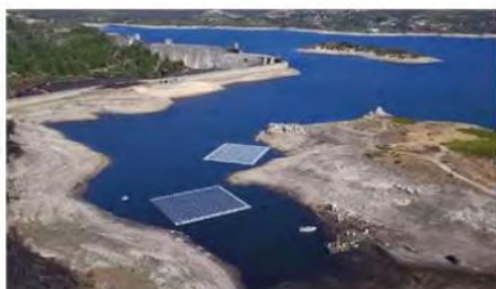
Figura 4A – Painéis fotovoltaicos flutuantes no espelho de água da albufeira do Alto Rabagão.
