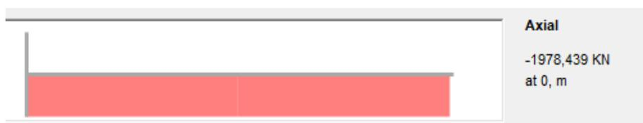
Fig. 26 – Esforço axial no pilar exemplo
