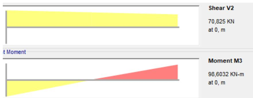
Fig. 25 – Esforço de corte e momento fletor no pilar exemplo
