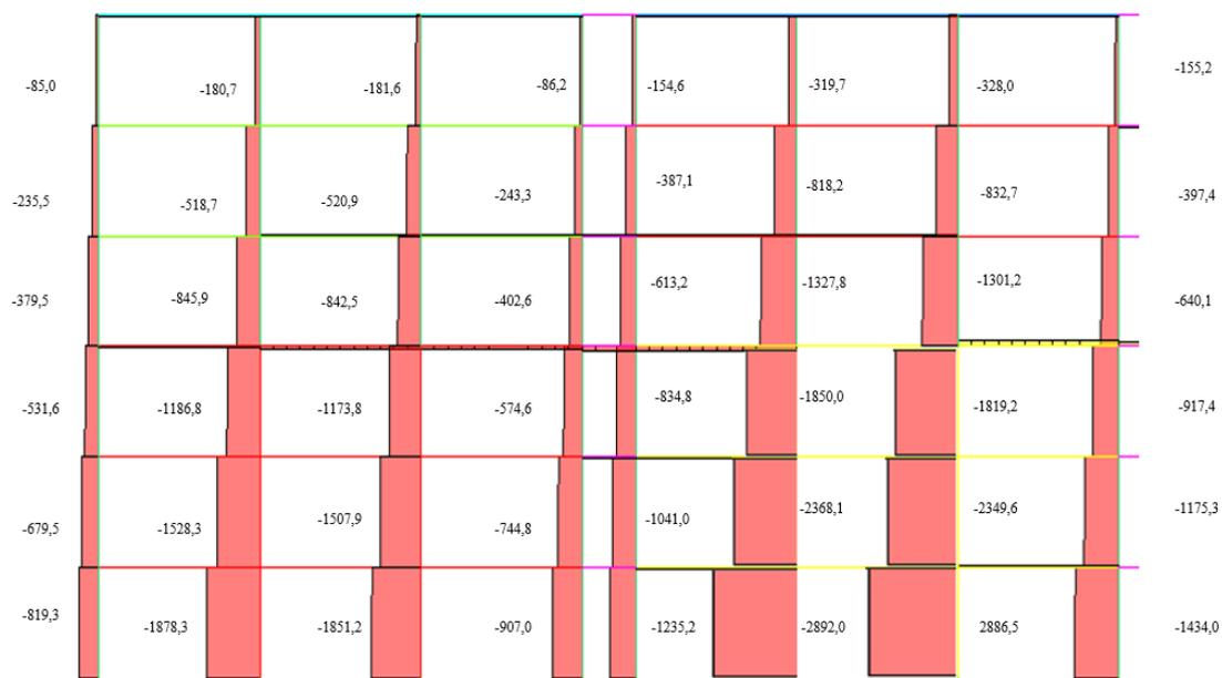
Fig. 20 – Esforços axiais na estrutura sem paredes (kN)
