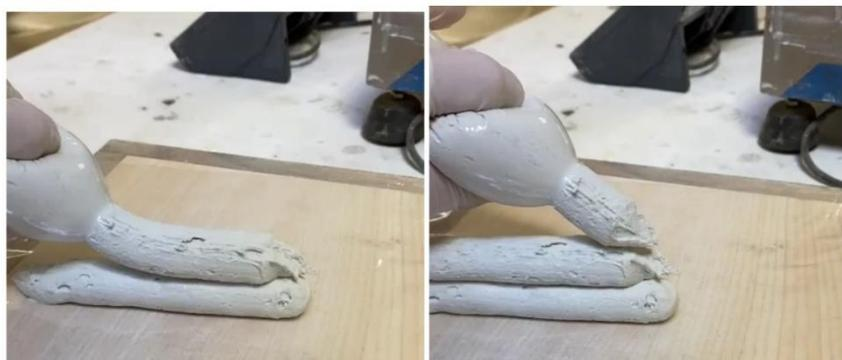
Figura 3 – Teste de impressão manual.
