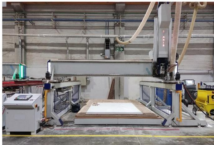
Figura 4 - Set-up para impressão 3D.
