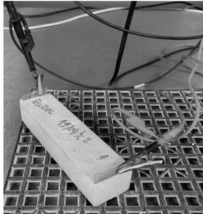
**Figura 2 – Provet ABAC – ensaio de resistividade elétrica.**
