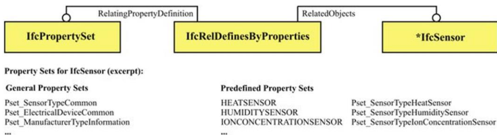
Figura 4 – Mapeamento da informação dos sensores em IFC utilizando Property Sets comuns a todos os sensores e alguns específicos a determinada enumeração [17]
