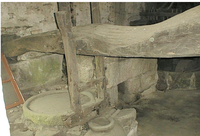
Figura 5.2- Mondim de Basto. Pormenor de prensa para vinho, com grande vigia em carvalho apoiada no vão existente na parede do lagar.
