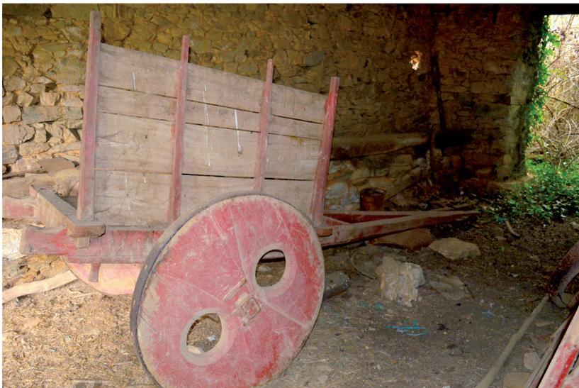
Figura 3.1- Bragança. Carro de bois com caniça, pintado a vermelho. A maioria das peças são em madeira de negrilho, e o eixo é em freixo.
