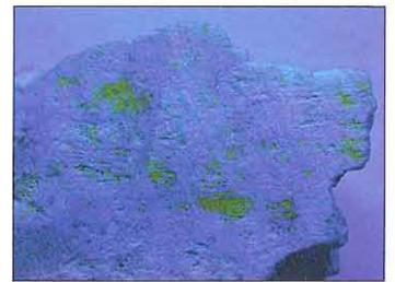
Fig. 2 : Mise en évidence du feldspath potassique (vert-jaune) par la méthode du colbatinitrite de sodium avec des reliques de pétalite (à droite de l'échantillon) – Cliché : A. Lima
