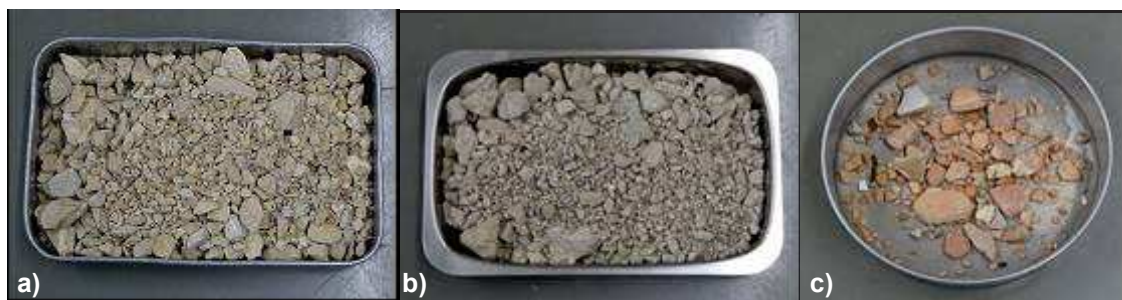
Figura 3 – Separação de alguns constituintes do RCD após a triagem manual: (a) agregados não ligados ( R_u ); (b) partículas de betão e argamassa ( R_c ); (c) elementos cerâmicos de alvenaria ( R_b )
