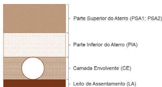
Figura 5 – Representação das categorias de materiais na vala (adaptado de Vieira et al. (2017))
