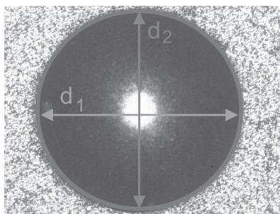
**Figura 1:** Diâmetros mensurados no ensaio de dureza Brinell.
