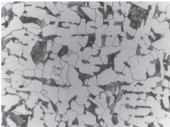
**Figura 4:** Imagem microscópica (346x) de um aço ABNT 1020 atacado com reagente nital 2.0%.
