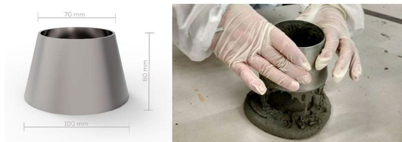
Figura 3. Molde tronco-cônico utilizado no ensaio de espalhamento.
