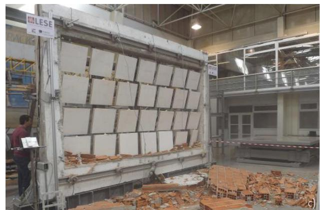
Figura 6 Parede não reforçada Inf\_09: Danos observados a) Padrão de fissuração; b) Vista lateral pré-colapso; c) Vista lateral pós-colapso
