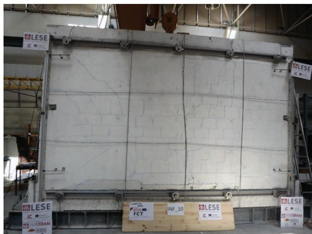
Figura 8 Parede Inf\_10: Padrão de fissuração
