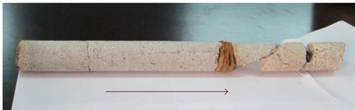
Figura 47 – Carote com zona de madeira a 29 cm. A seta indica o sentido do exterior para o interior, 2014.
