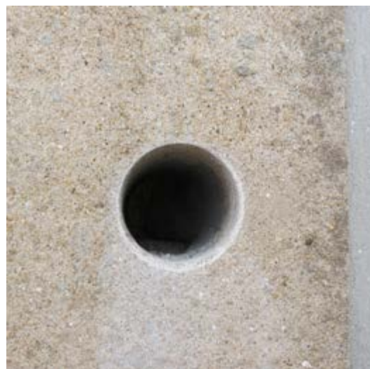
Figura 51 – Extração de carote em pano liso, 2013.
