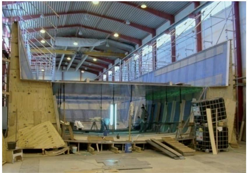
Figura 12 – “Catamaran” (Cabine compósita por infusão a vácuo com molde aberto, numa única peça)
