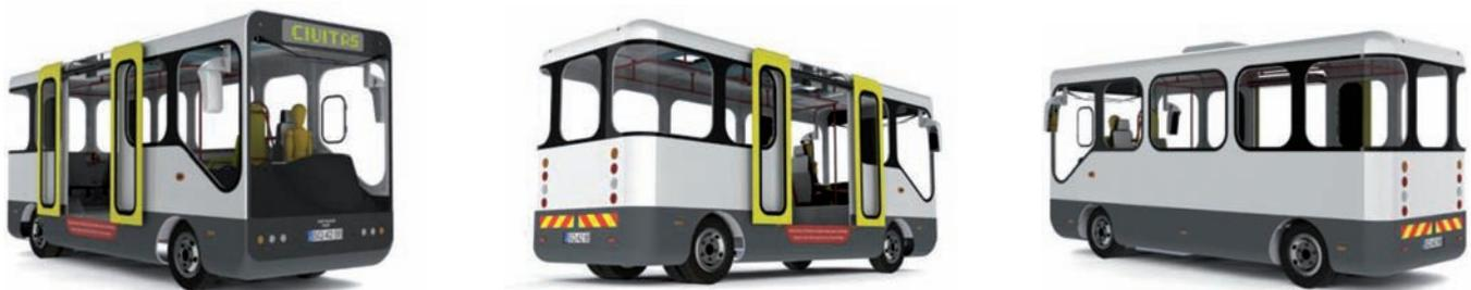
Figura 11 – Conceito final adaptado ao chassis Toyota Coaster
