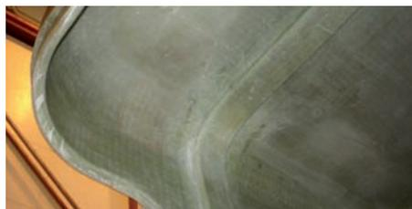
Figura 19 – Transposição em curvatura, do tejadilho para os painéis laterais e traseiro
