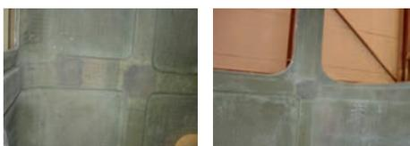
Figura 20 – Aspecto dos inserts integrados no núcleo do sanduíche (contraplacado marítimo e metal)
