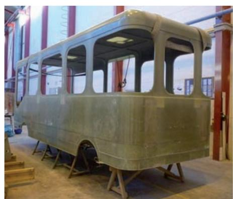
Figura 21 – Aspecto geral da carroçaria após colagem (sem acabamento superficial após desmoldagem)
