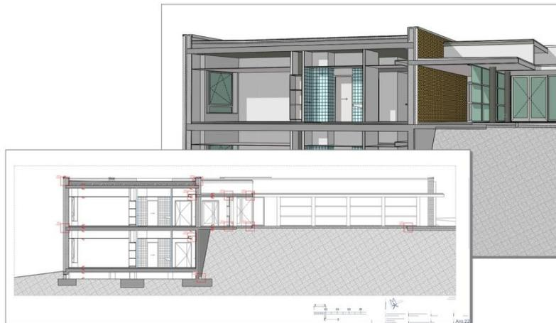
Peças desenhadas retiradas a partir de uma ferramenta BIM [12].
