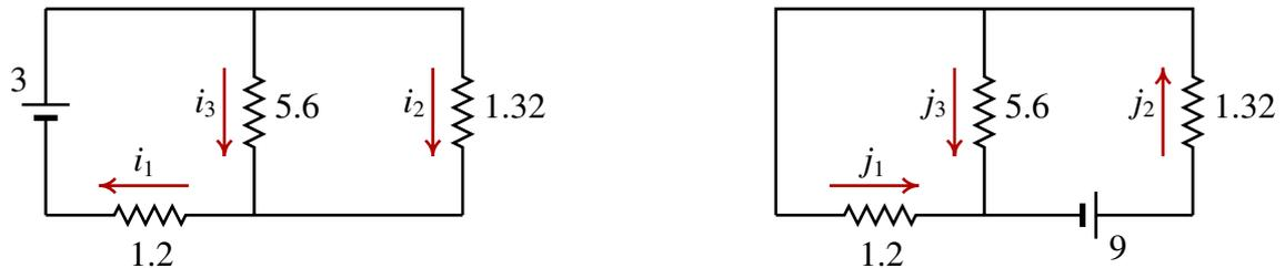
Em cada circuito estão indicadas as correntes nas resistências, em unidades de mA. Note-se que essas já são as correntes reais e não as correntes de malha. No circuito do lado esquerdo, a resistência total é:  $(5.6 \parallel 1.32) + 1.2 = 1.0682 + 1.2 = 2.2682$
