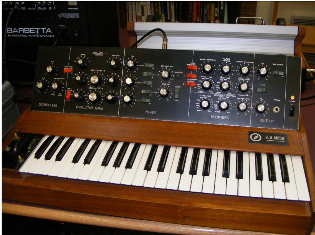
Um sintetizador é um instrumento musical baseado no processamento de sinais eléctricos. É produzida uma tensão eléctrica oscilatória que é logo processada passando por vários filtros que alteram a forma da função que representa a tensão em função do tempo. O sinal de saída é alimentado num altifalante produzindo o som desejado. A fotografia mostra um sintetizador Moog, modelo Minimoog, de 1970.
