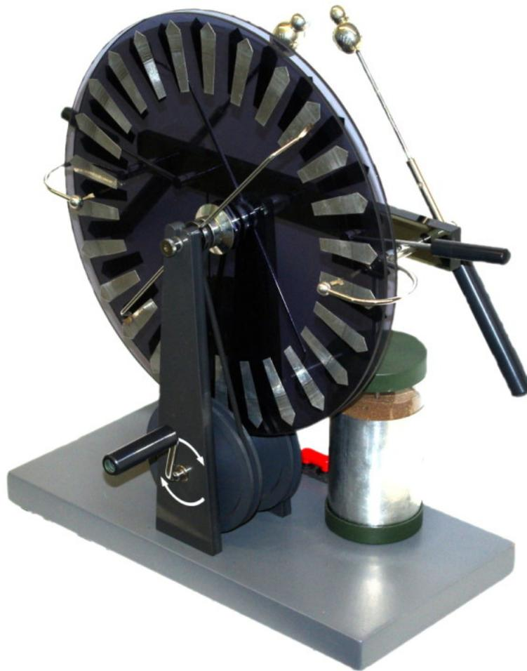
A fotografia mostra um gerador de Wimshurst, inventado na década de 1880. Já no século XVIII existiam máquinas eletrostáticas usadas para gerar cargas eletrostáticas por atrito; a grande inovação de Wimshurst foi a utilização da **indução eletrostática**, o que permitiu produzir cargas muito mais elevadas por meios mecânicos. Há diversos mecanismos envolvidos no funcionamento do gerador de Wimshurst, que serão estudados nos próximos capítulos: garrafa de Leiden, rigidez dielétrica, etc.
