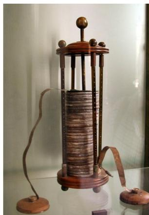
Figura 2.2.: Pilha de Volta.
