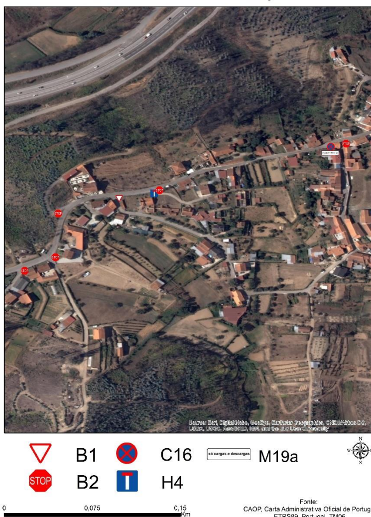
Figura 24 - Mapa da sinalização atual, com a sinalização proposta para a segunda área de intervenção da localidade de Paredes.
