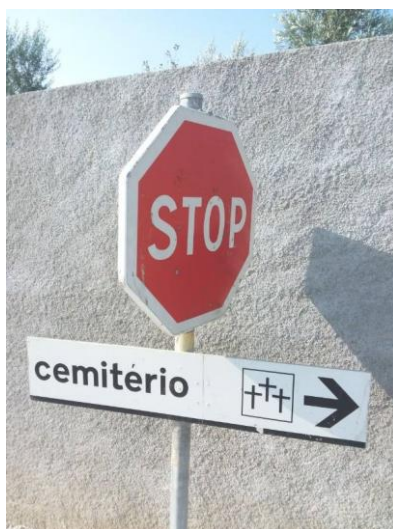
Figura 12 - Sinal de cedência de passagem, do tipo B2 em conjunto com uma seta direcional.
