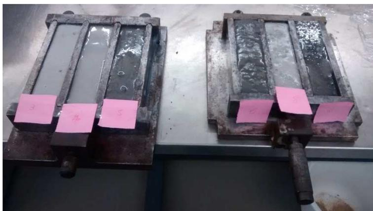
Figura 1 - Provetes preparados em moldes metálicos antes de desmoldar
