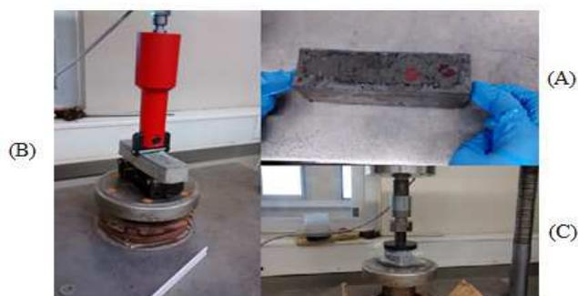
Figura 3 - Provete desenformado (A) e logo após ensaiado a flexão (B) e compressão (C)
