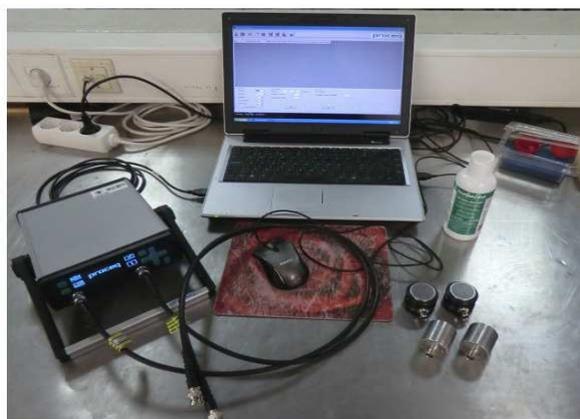
Figura 2 - Aparelho de aquisição de ondas P e S (Rios et al., 2015)
