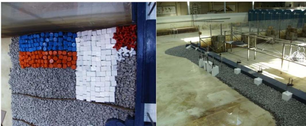
Figura 6 – Construção da cabeça do quebramar norte – a barlar (esquerda); intradorso do quebramar norte e Posto “A” (direita).
