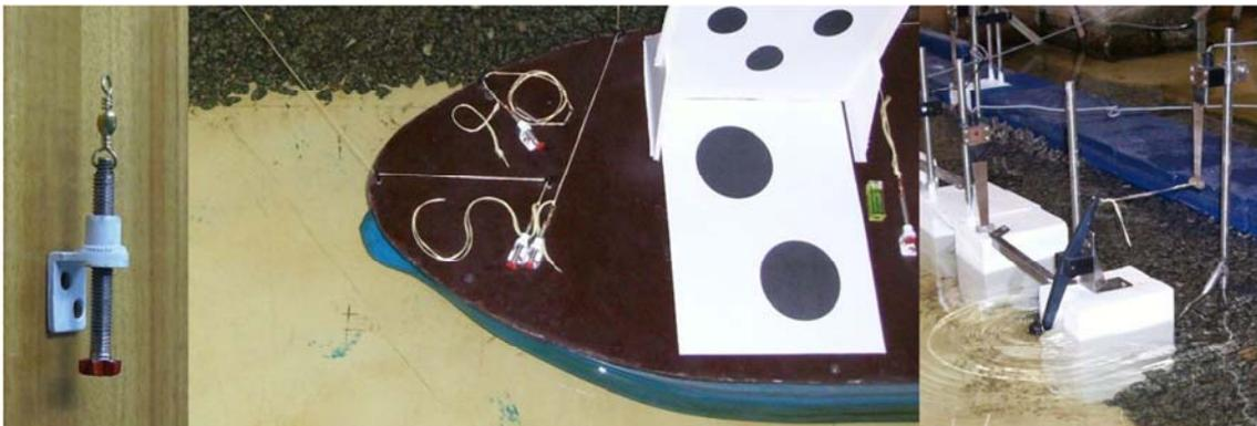
Figura 9 – Pormenor do mecanismo de ajuste das forças aplicadas nos cabos de amarração (esquerda); posição dos quatro mecanismos instalados à proa do modelo do navio (centro); dispositivo de simulação das defensas (direita).
