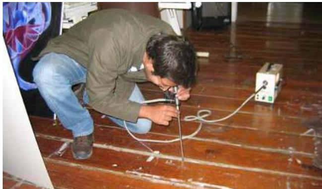
**Figura 8. Utilização do videoscópio para visualização de um pavimento do Palácio de Belomonte, séc. XVIII, Porto.**
