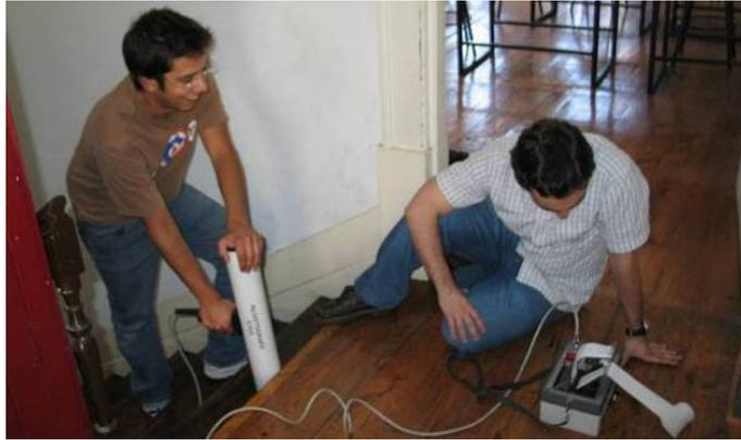
**Figura 9. Utilização do Resistograph para avaliação da integridade de elementos estruturais de escadas de madeira, Edifício São Domingos, séc. XIX (1856), Porto.**
