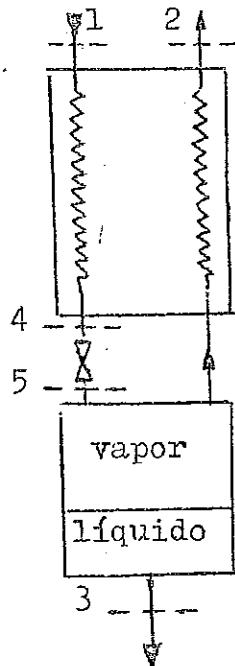
Este contém líquido e vapor em equilíbrio a 25°C e o vapor que deixa o permutador está a 70°C. Desprezando todas as perdas de pressão com exceção da verificada na válvula de expansão, determine:
