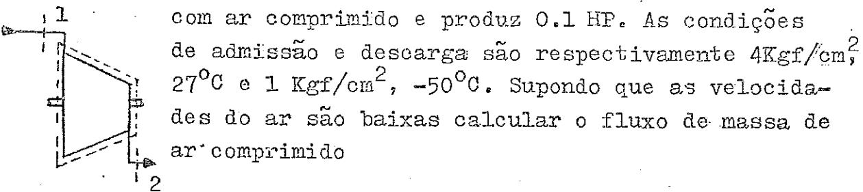
com ar comprimido e produz 0.1 HP. As condições de admissão e descarga são respectivamente 4Kgf/cm<sup>2</sup>, 27°C e 1 Kgf/cm<sup>2</sup>, -50°C. Supondo que as velocidades do ar são baixas calcular o fluxo de massa de ar comprimido
