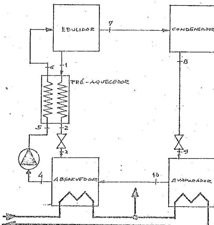
Do diagrama apresentado podemos concluir que o calor rejeitado, por Kg de refrigerante condensado é
