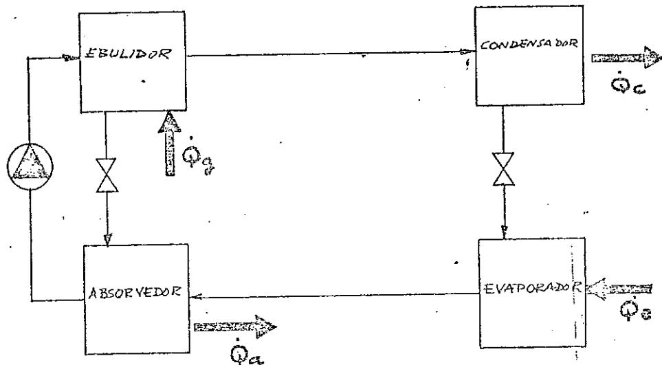
Representa-se na figura um esquema simples do princípio de funcionamento dum ciclo de refrigeração (ou bomba de calor) por absorção.
