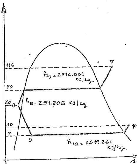
Recorrendo agora ao diagrama de concentrações, podemos concluir que, para a concentração que a solução mantém no ebulidor, 58.5%, a temperatura de equilíbrio é de, aproximadamente, 116°C, valor este que se indica já sobre o diagrama anterior, como sendo a temperatura a que o refrigerante, vapor de água, deixa o ebulidor ou gerador.
