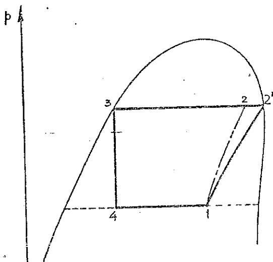
**PROBLEMA 6** - Uma bomba de calor utilizando amoníaco como fluido de trabalho, opera entre os limites de 4°C e 50°C (temperatura de saturação no condensador). Se o fluido de trabalho entrar saturado no compressor, e for condensado até líquido saturado, calcular o coeficiente de performance do ciclo ideal.
