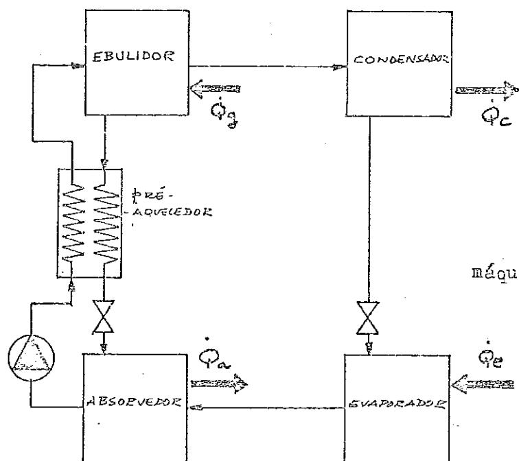
Esquema de princípio de uma máquina usando água - BrLi
