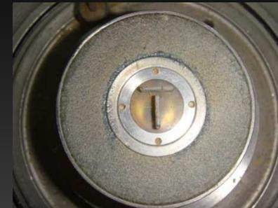
*Bender-extender elements ou transdutores piezocerâmicos*
