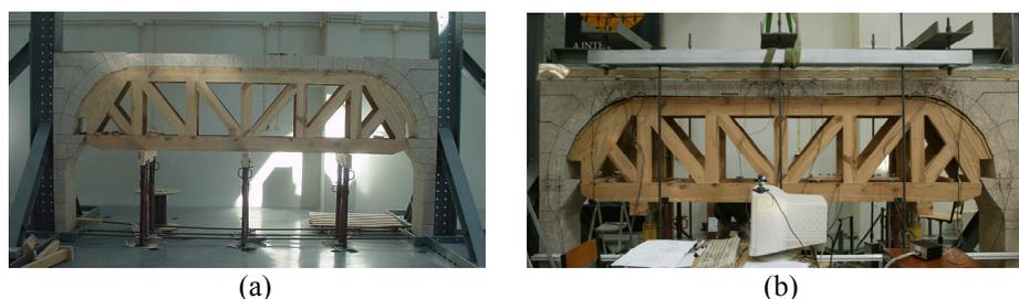
Figura 2: Modelo experimental à escala 1:2 do arco do coro da igreja dos Terceiros. (a) arco isolado e (b) arco com dispositivo de carregamento vertical.
