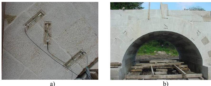
Figura 18: Instrumentação de juntas. (a) Configuração em Z dos transdutores de deslocamento e (b) localização dos transdutores de deslocamento num arco.
