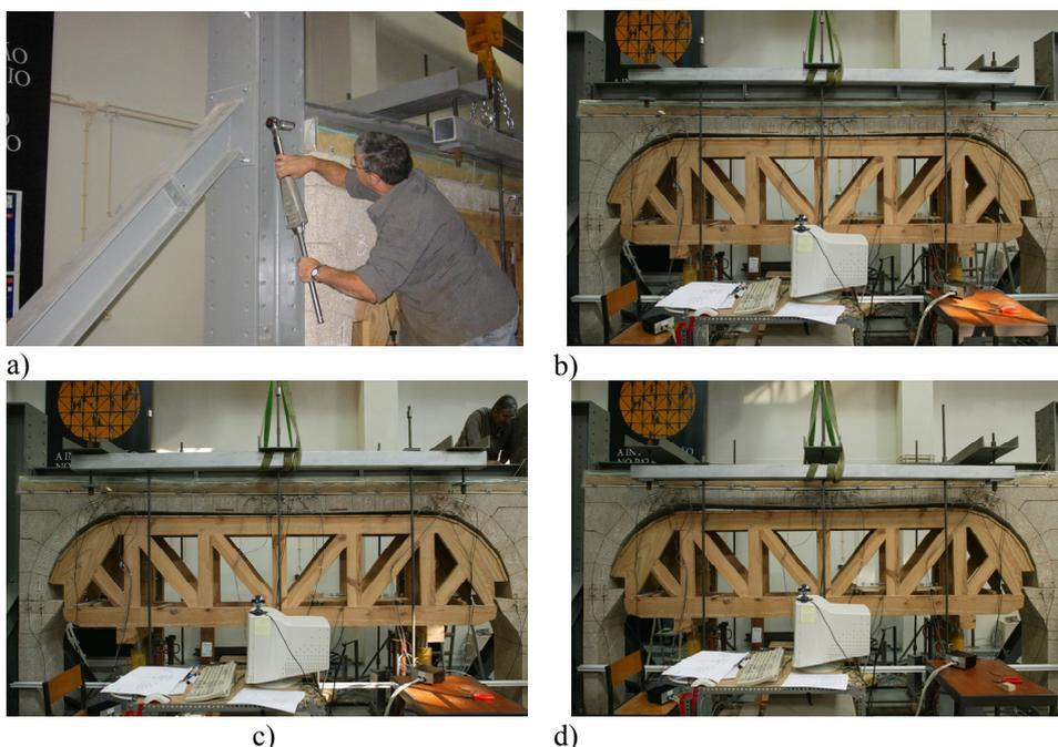
Figura 5: Sequência do ensaio. (a) Aperto dos tirantes, (b) descida do cimbre, (c) colocação da estrutura de repartição de cargas e (d) aplicação de carga vertical crescente.
