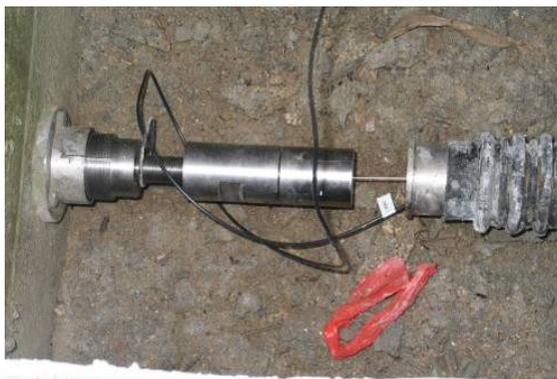
Figura 21: Sensores longos transversais. Zona de amarração no muro-tímpano.
