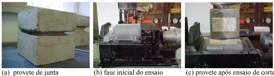
Figura 8: Ensaio de caracterização das junta.
