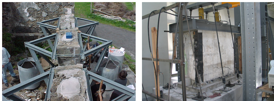
a) Ensaio no Faial em paredes de alvenaria de moradias
