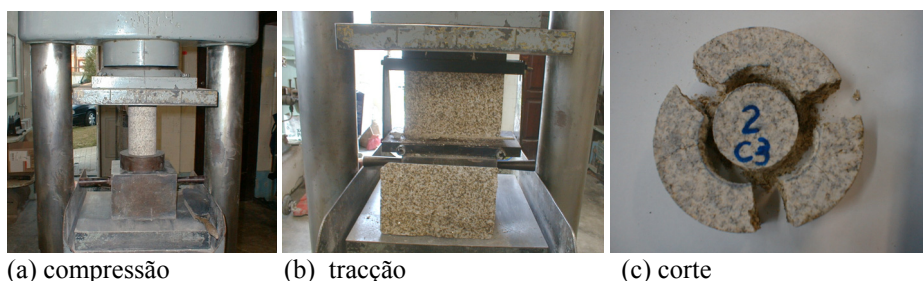
Figura 7: Ensaio sobre carotes de pedra.
