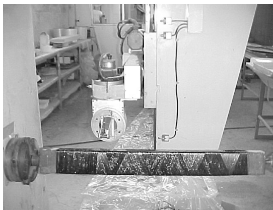
Figura 6 : Viga reforçada por enrolamento filamental
