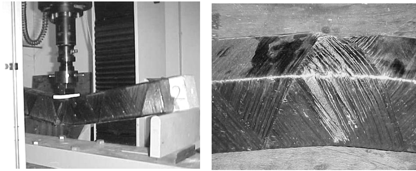
Figura 11 : (Esq.) Flecha máxima de uma viga reforçada com 2 camadas; (Dta.) Rotura das fibras após ensaio .
