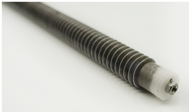
Figura 2 Tubo corrugado utilizado no ensaio de retração autogénea
