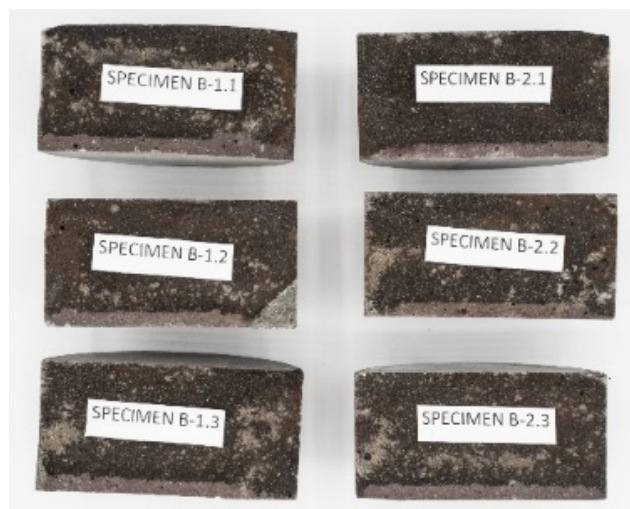
Figura 9 Superfícies divididas dos provetes cilíndricos após ensaio de resistência aos cloretos aos 28 dias; entrada de cloretos pelo lado da superfície inferior (profundidade de penetração de iões de cloreto na parte mais clara)
