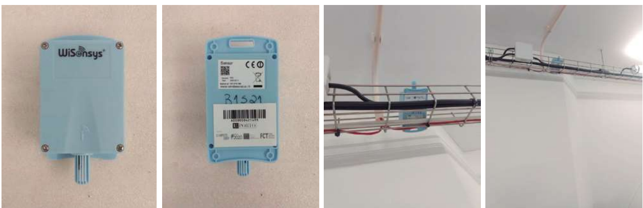
Exemplo de sistema de monitorização ambiental do contexto de reserva do conjunto fotográfico científico de Mendes Correia, no acervo do Museu de História Natural e da Ciência da Universidade do Porto. Sensor, de tipo "datalogger", para monitorização de humidade relativa e temperatura e respetiva localização (2020, ECPDGF da FLUP©, fotografia de Karina Fernandes 40 ).
