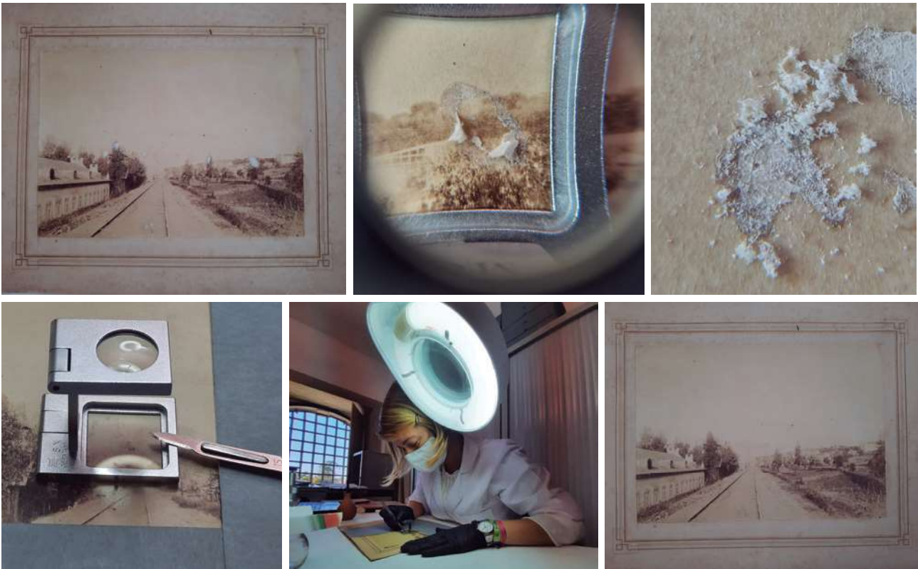
Exemplo de limpeza de prova fotográfica sobre cartão da Coleção de Autores Não Identificados, do Arquivo Distrital do Porto. Prova em albumina, antes de intervenção e com resíduos de papel aderidos. Detalhes de resíduos de papel não eliminados por via mista, previamente adotada. Lupa conta-fios e bisturi. Intervenção por via mecânica, através de bisturi, com auxílio da lupa. Prova após intervenção (2020, ECPDGF da FLUP©, fotografia de Sara Malhado 37 ).
