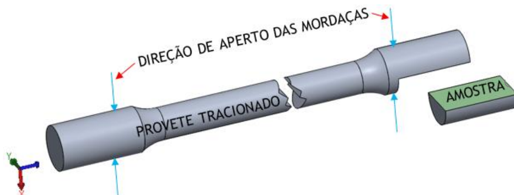
Figura 36 - Esquema de obtenção da amostra da cabeça do provete mais próxima do gito de descida
