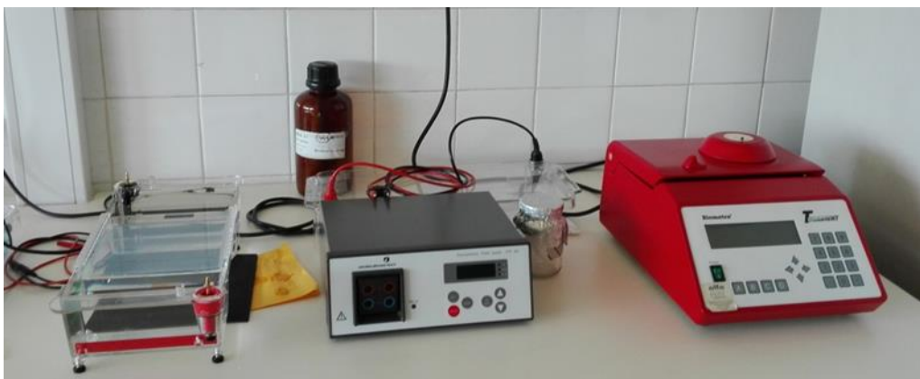
Figura 2 - Termociclador T Gradient (Whatman – Biometra, Gottingen; Germany) e análise dos resultados do PCR por eletroforese em gel de agarose.
