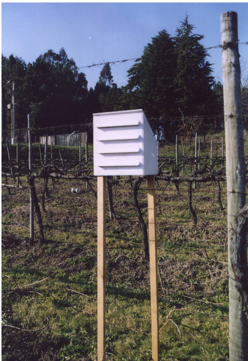
Abrijo meteorológico construído para este projecto
